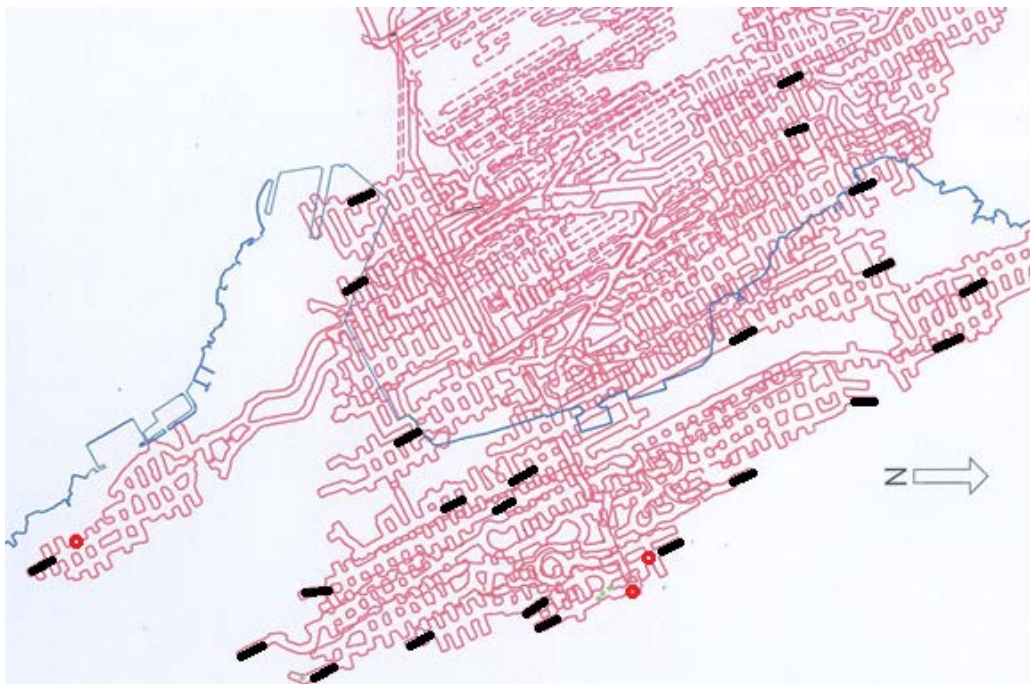
Figur 13 Gruveområdet hvor bergslag har funnet sted (vist av røde, små ringer). Svarte små streker i stollene viser enkelte av stedene hvor det er foretatt omfattende bergbolting.
