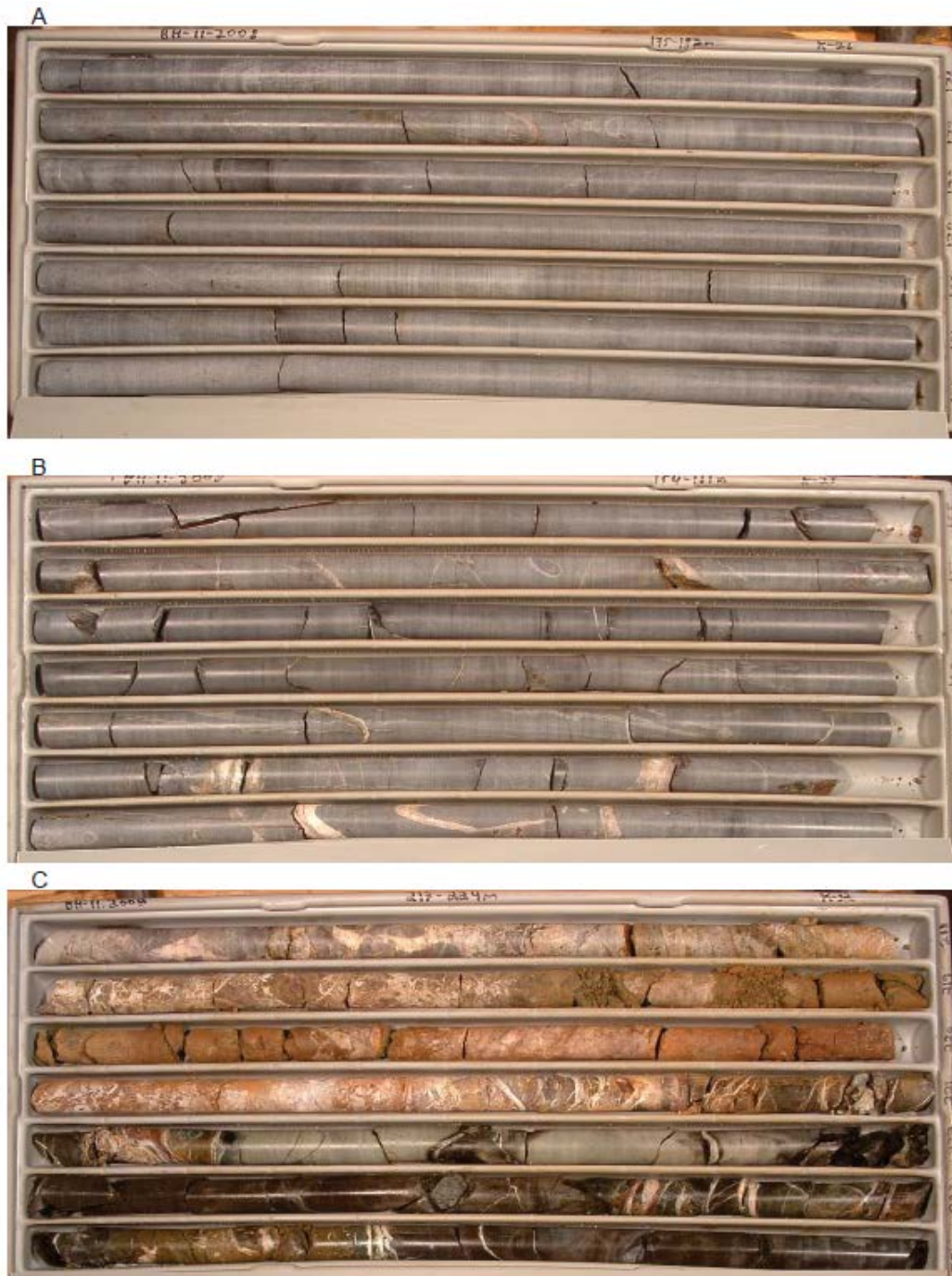
Figur 10. Eksempler på borkjerner fra et 504 m langt borhull påsatt i Dalen gruve under Eidangerfjorden (Nivå -240). Kasse A viser hel og fin standard Dalen kalksten; mørke sprekker fremkom under kjernebehandlingen etter opptak. Kasse B viser det samme, men gamle sprekker er limt sammen av kalkspatt. I Kasse C går hullet inn i en forkastning; man aner rester av kalkstein øverst til venstre. De neste 4 m er en kalkspattbreksje med rustbrune, jordaktige masser. Hullet går så inn i hornfels fra Fossum fm. i ligger av kalksteinen. Spranghøyden i forkastningen er ca. 40 m og det seg inn vann med saltsmak.
