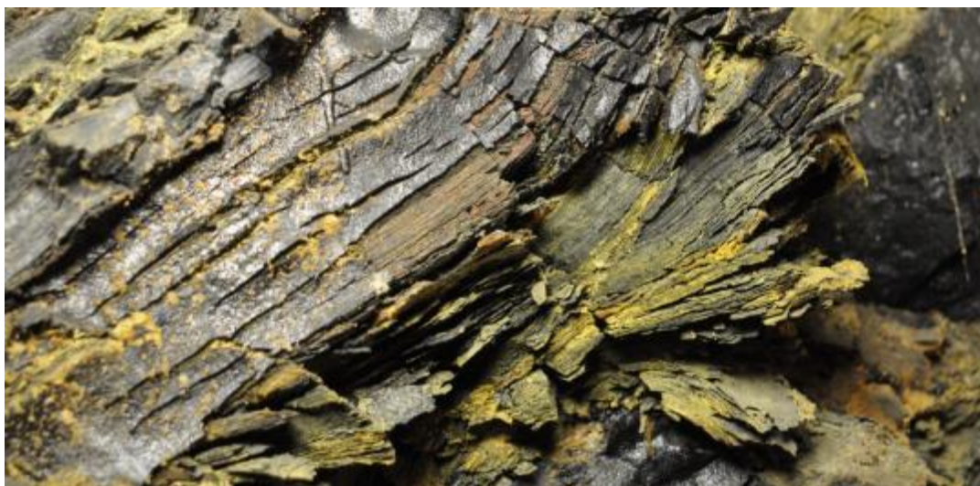
Figur 3. Alunskiferprøve som er oksidert og forvitret ved kontakt med oksygen og fuktighet. Gulffarge indikerer utfelling av jernoksider/sulfater (høyden på bildeutsnittet er ca. 5 centimeter) (Kilde: NGI).
