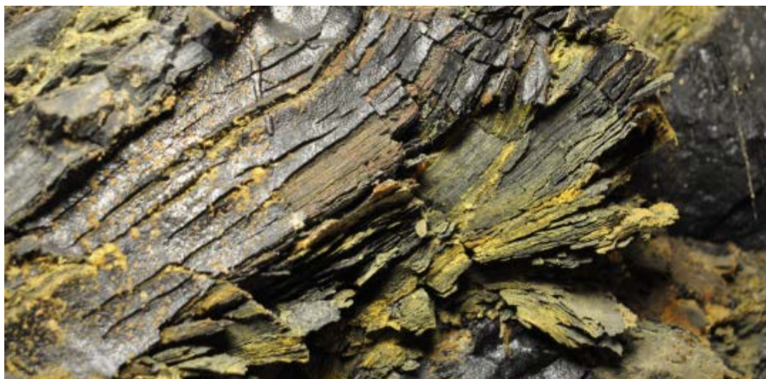
Figur 41 Alunskiferprøve som oksyderes og forvitres ved kontakt med oksygen og fuktighet. Gulffarge indikerer utfelling av jernoksider/sulfater (høyden på bildeutsnittet er ca. 5 centimeter) (NGI, 2015).
