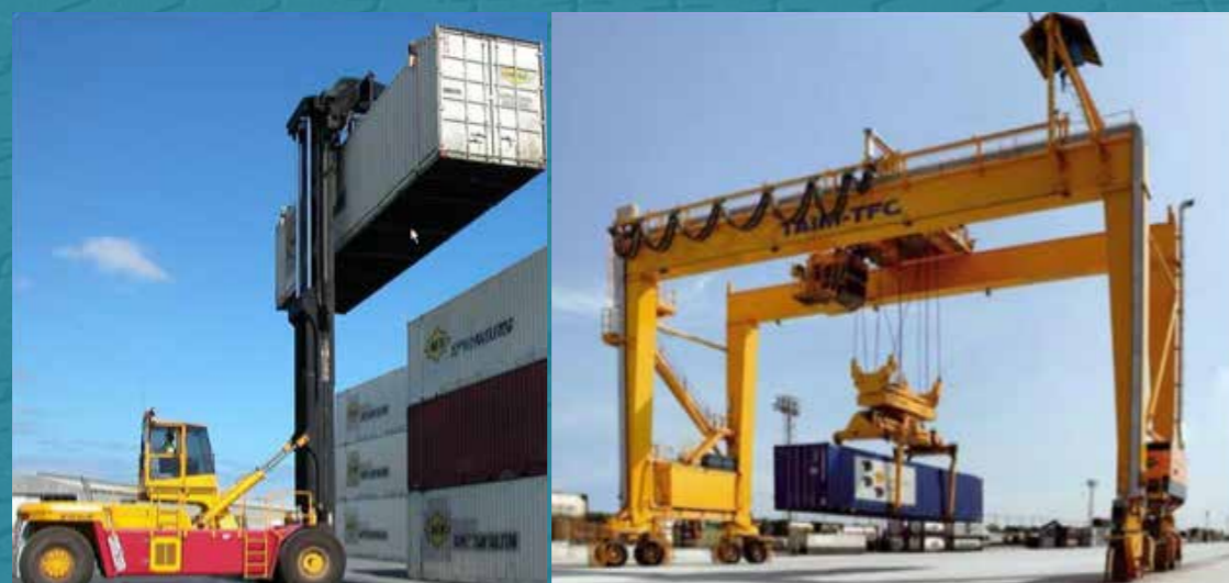
Fig. 4. Typer containerhåndteringsutstyr Containertrucker (venstre) og RTB, rubber tired gantry kraner (høyre).
