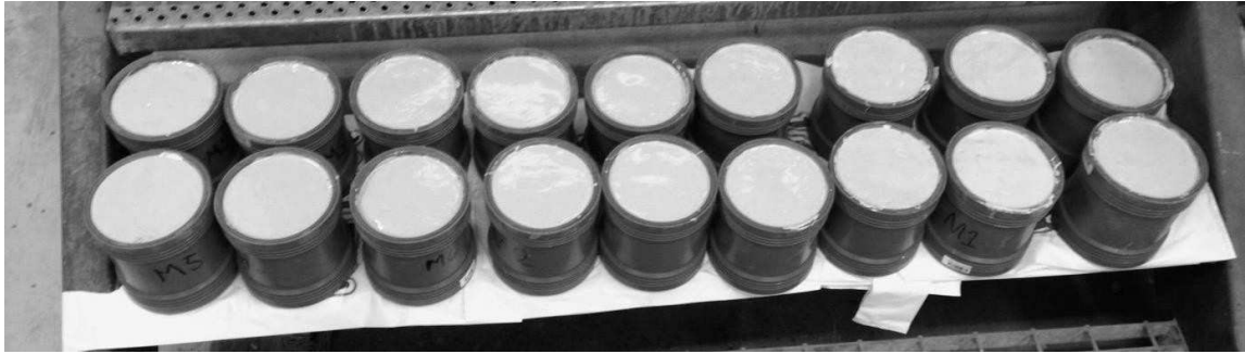
Figur 1: Ferdig forseglet betongprøver
